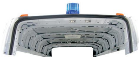
Abb.: Innenaufbau des Hochdachs mit werkseitig integrierter Verstärkung
