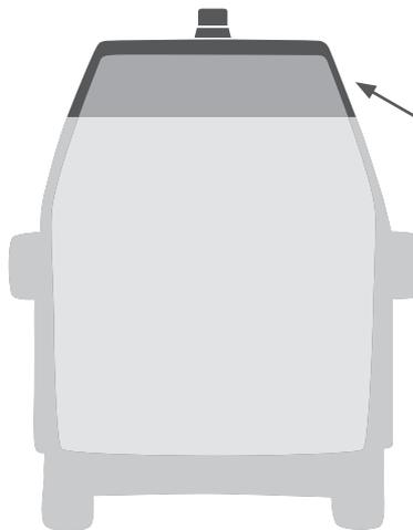
Zugewinn der Beladeöffnung durch Verwendung des Original-Ford-Hochdachs.
